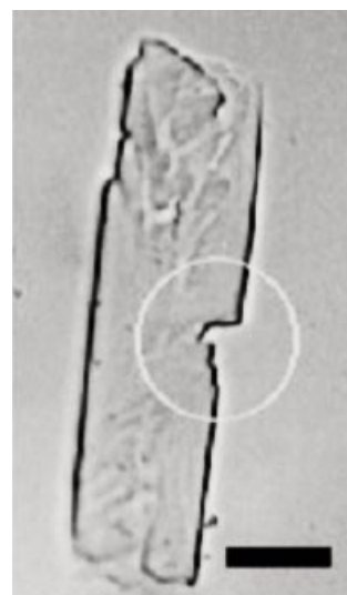
Abbildung 6. Lichtmikroskopische Aufnahme der (010)-Ebene von Brushit in einer Poly(L-(+)-lysin)-Lösung. Die Länge des eingezeichneten Balkens entspricht 200 \mu\text{m} .
